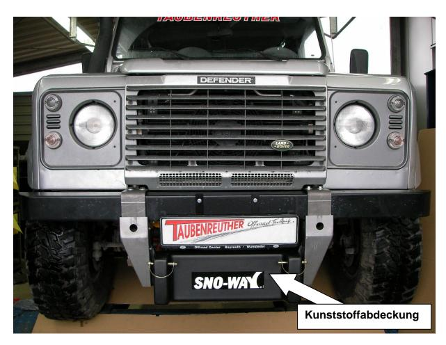
Hier sehen sie den fertig montierten Schneepflugabstützsatz. Bevor sie mit der Montage beginnen lesen sie bitte diese Anleitung gut durch.
